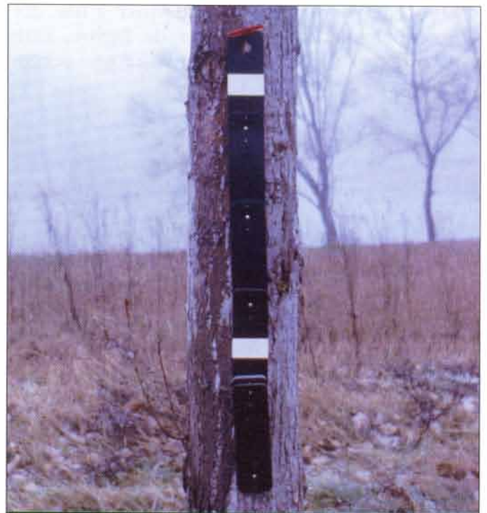
Une mire, fixée sur l'arbre, permet, à l'aide d'un système télémétrique, de se positionner directement à la bonne distance.
